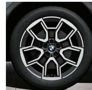
19インチ アロイ・ホイール Vスポーク・スタイリング867 バイカラー(ダーク・グレー)*1*5 : 8J×19ホイール、245/45R19タイヤ
